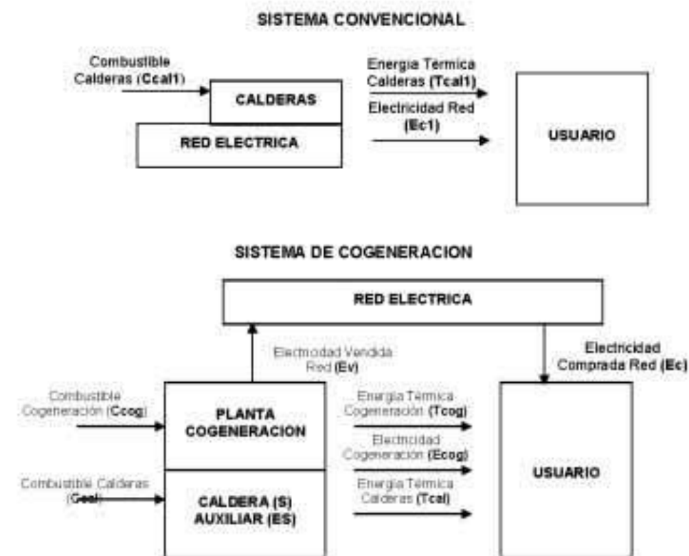
Figura 1. Comparación entre un sistema de convencional y un sistema de cogeneración.
